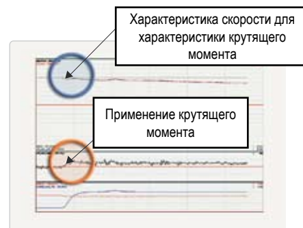
Защита механизма, обеспеченная функцией ограничения крутящего момента
