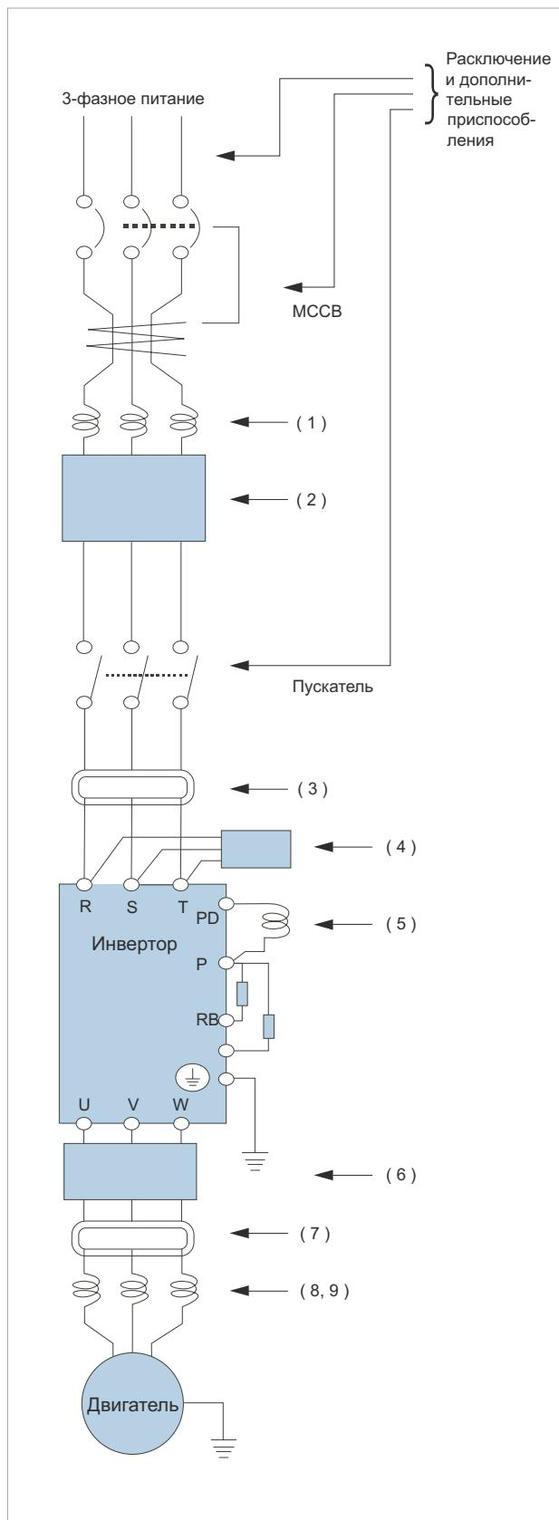
Чувствительность автоматического выключателя в литом к корпусу (MCCB) к утечкам тока зависит от суммарной длины проводов между частотным преобразователем и источником его питания и между частотным преобразователем и электродвигателем.
