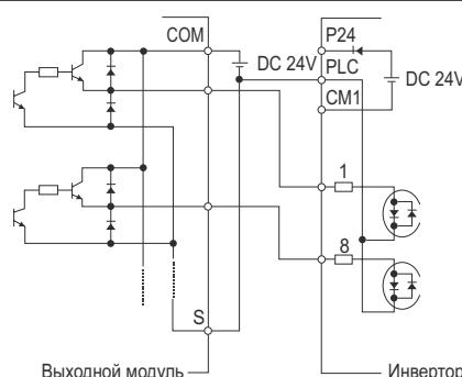
После включения программируемого логического контроллера и его внешнего источника питания обязательно включите частотные преобразователи, чтобы их внутренние параметры не подверглись изменениям.
